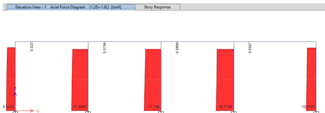
Figura 22. Diagrama de fuerzas axiales eje 1 combinación 1.2D+1.6L (sentido X)
