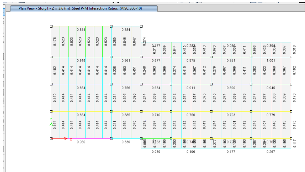
Figura 31. Ratios Demanda/Capacidad vigas y viguetas Nivel +3.20
