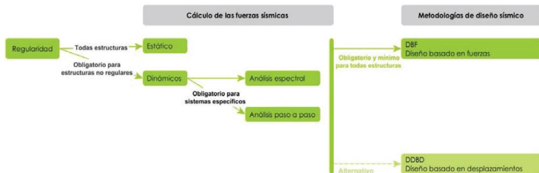
Figura 14. Tipos de Análisis de la NEC-SE-DS
