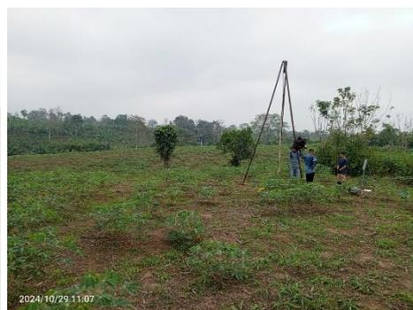
Estrato # 1.- De: 0.0 a -1.00.- Espesor 1.0 m. (entre cotas (224 a 223), constituidos por: Limo arcilloso inorgánico, color café claro, contiene arena fina, son de alta plasticidad, no expansivos, alta compresibilidad, poco permeables, consistencia Blanda (Suelta), capacidad de soporte Muy Baja. Tipo M H. SEGÚN CLASIFICACION S.U.C.S.
