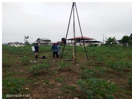
Estrato # 1.- De: 0.0 a -1.00.- Espesor 1.0 m. (entre cotas (225 a 224), constituidos por: Limo arcilloso inorgánico, color café claro, contiene arena fina, son de alta plasticidad, no expansivos, alta compresibilidad, poco permeables, consistencia Blanda (Suelta), capacidad de soporte Muy Baja. Tipo M H. SEGÚN CLASIFICACION S.U.C.S.
